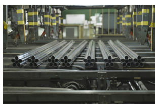
アルミ建築廃材を再生利用した torch の製造の様子
