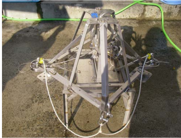
図3.2-3 スミス・マッキンタイヤ型採泥器
