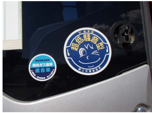
写真 8.2-4 超低騒音型建設機械
