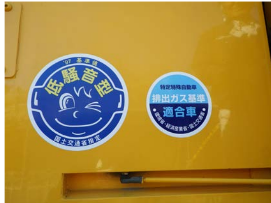
写真 8.2-2 低騒音型建設機械
