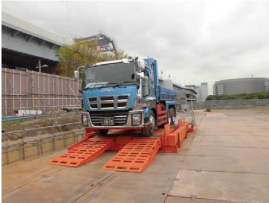
写真 8.1-1 タイヤ洗浄機
