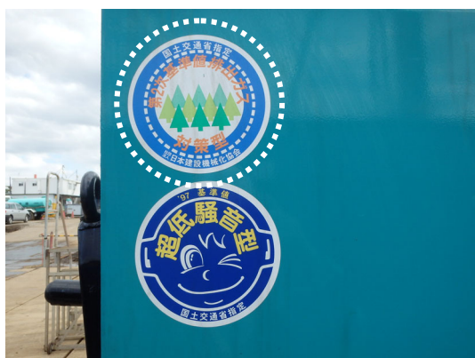
写真 8.8-1 排出ガス対策型建設機械（第2次基準値）
