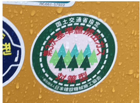
写真 8.8-6 排出ガス対策型建設機械 (第3次基準値)
