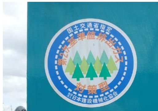
写真 8.1-8 排出ガス対策型建設機械(第2次基準値)
