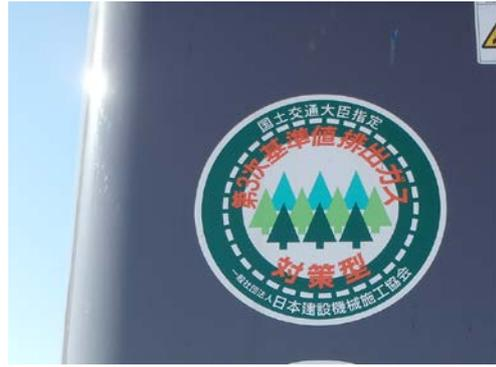
写真 8.1-10 排出ガス対策型建設機械(第3次基準値)
