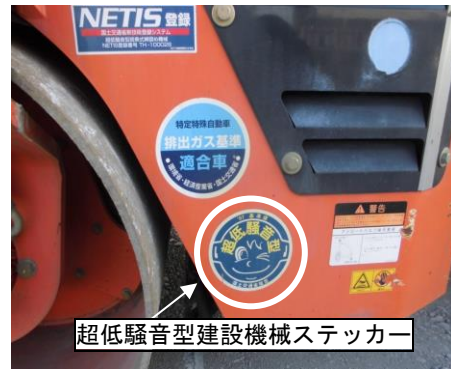
写真 8.2.2-8 超低騒音型建設機械の採用
