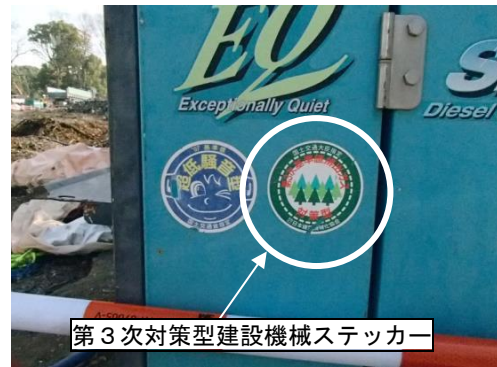
写真 8.6.1-10 排出ガス対策型建設機械の採用
