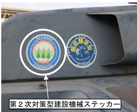
写真 8.2.3-3 排出ガス対策型建設機械の採用
