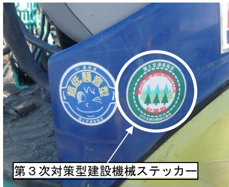
写真 8.2.3-5 排出ガス対策型建設機械の採用
