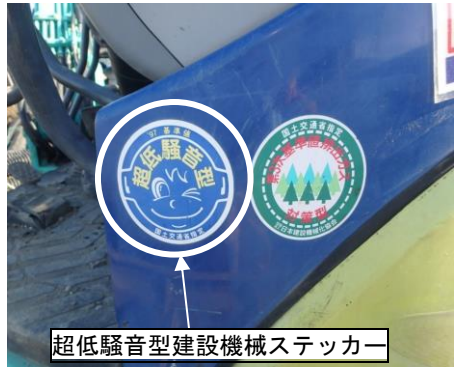
写真 8.2.2-9 超低騒音型建設機械の採用
